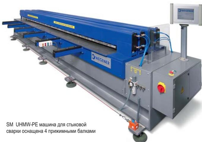
SM UHMW-PE машина для стыковой сварки оснащена 4 прижимными балками
